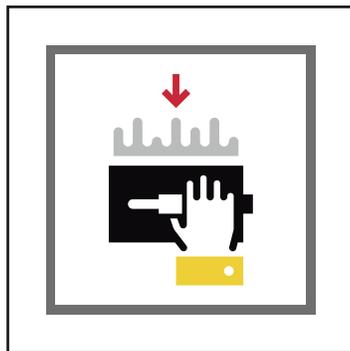
Con una llana metálica aplique una fina capa de masilla Supermastick PR® en el área a cubrir.
